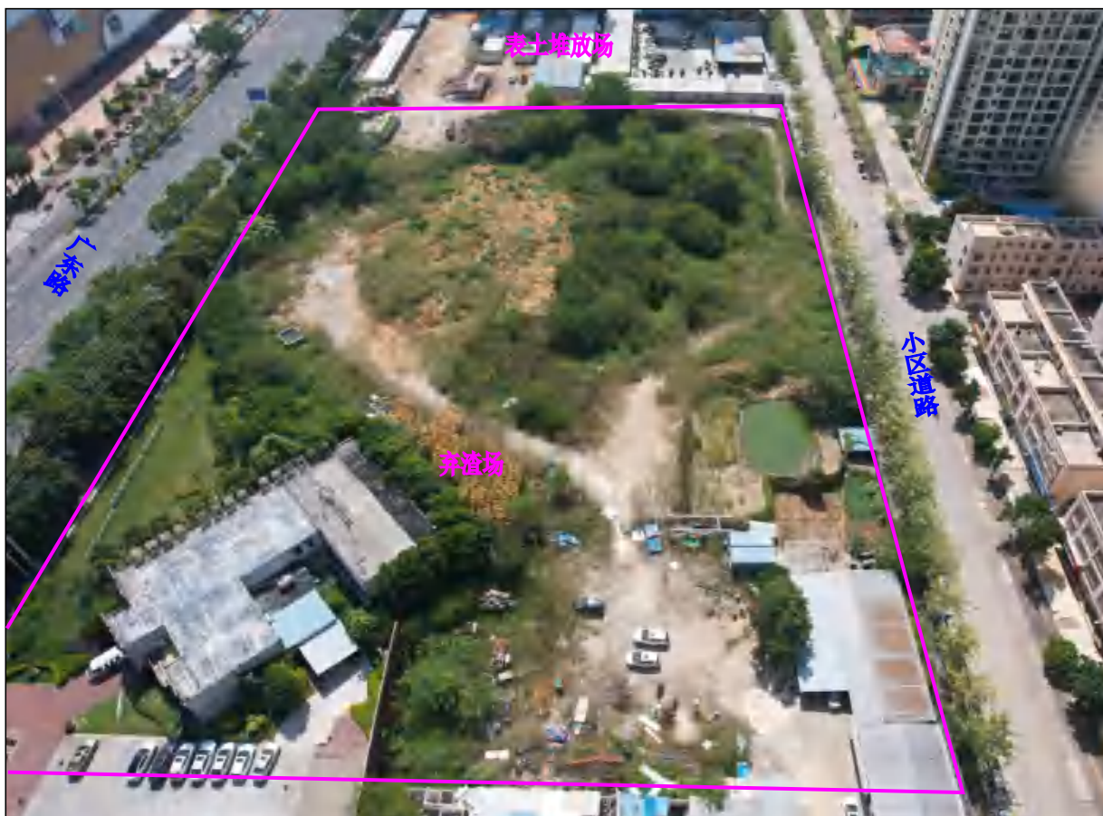
弃渣场用地现状图（2022年10月拍摄），弃渣已采取绿化措施，大部分区域现状植被生长状况较好，但小部分区域因车辆碾压等，无植被生长，弃渣场现状存在一定水土流失
